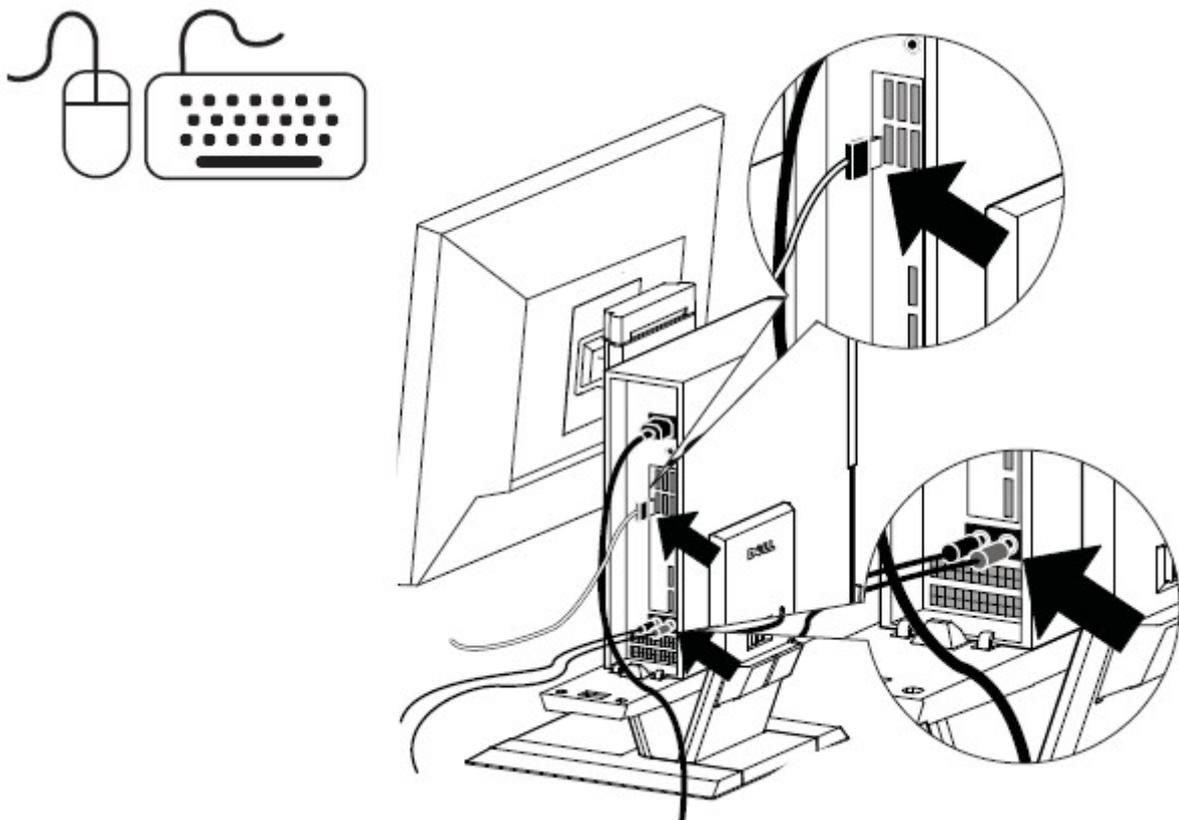
**10** Infilare i cavi ed i cavi d'alimentazione nel fermaglio sul retro della base AIO.
